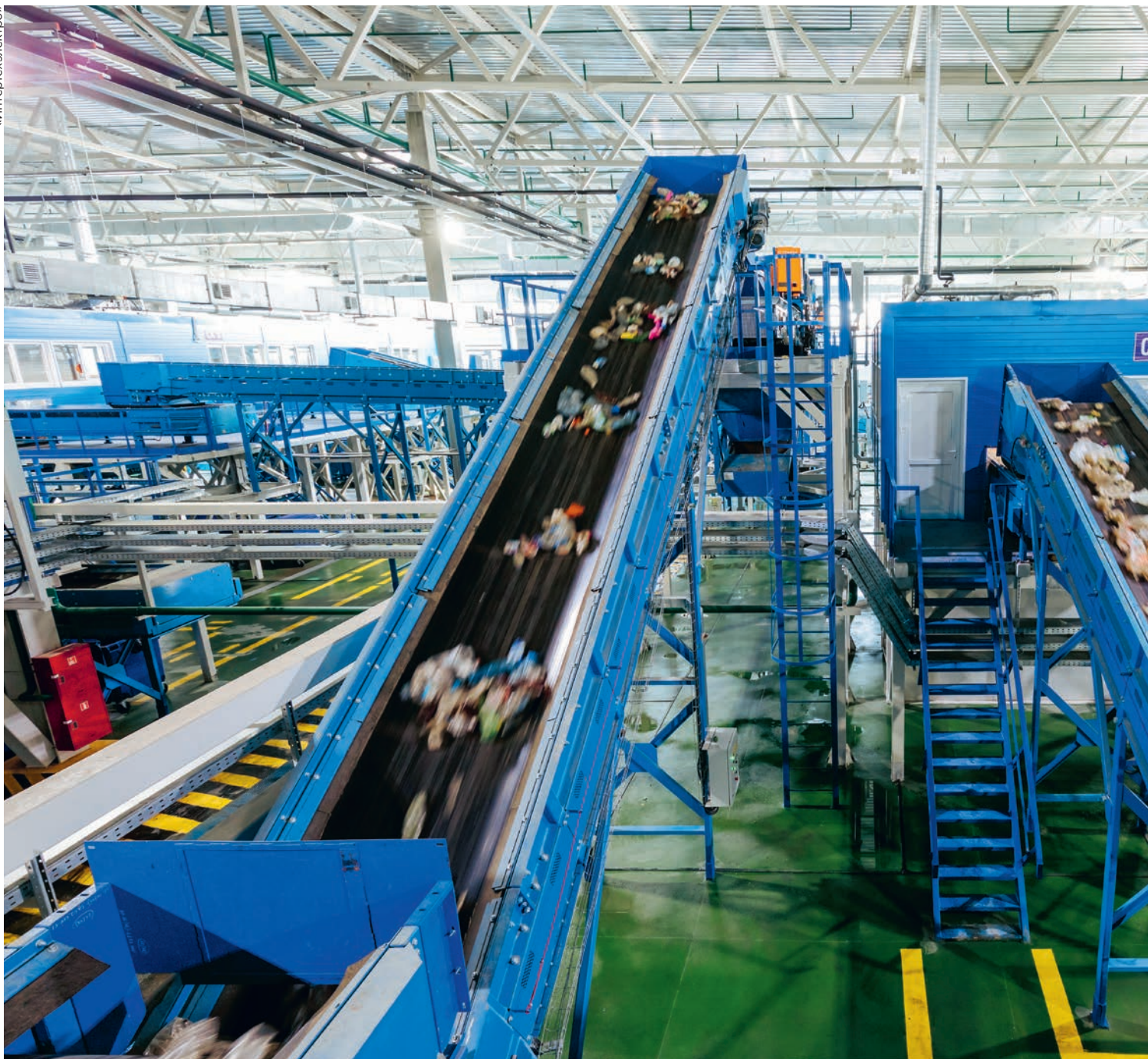
Бумага, пластиковые бутылки, алюминиевые банки и другие отходы перемещаются по цеху по конвейерным лентам.
